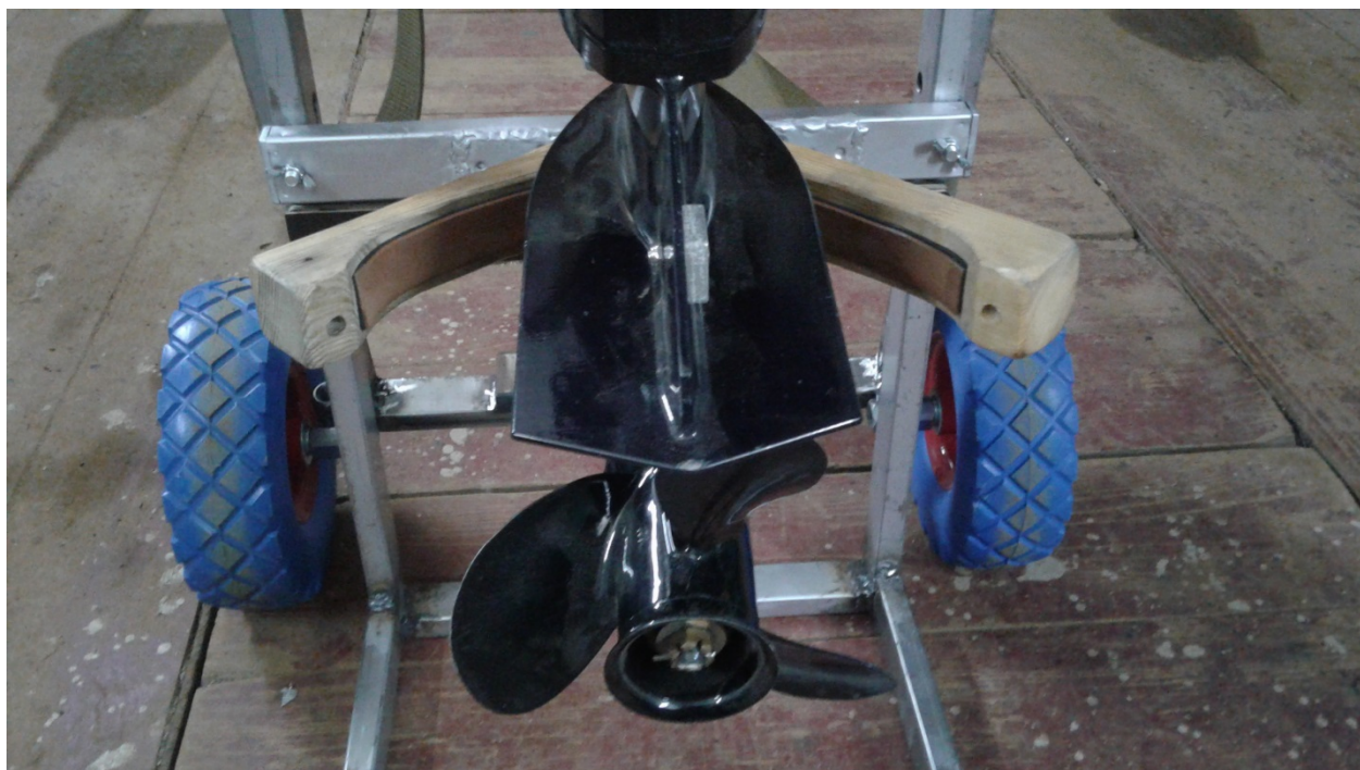
Установка скобы на тележку
