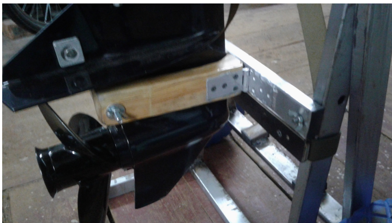
Закрепление «ноги» мотора.
